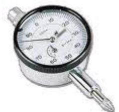
comparatore, assicurando così che il tastatore sia perennemente in contatto con l'oggetto di misura. Quando la superficie si sposta nella direzione dell'asse dell'asta (avvicinandosi o allontanandosi), anche quest'ultima si muove. Un sistema di lettura amplifica e visualizza questo spostamento rendendo disponibile la misura.
