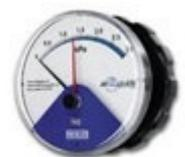
La pressione differenziale (o la pressione differenziale sull'orifizio) fa muovere l'astina della membrana. L'asta è collegata alla membrana di misura supportata dalle molle. Questa variazione della corsa che è proporzionale alla pressione differenziale viene trasmessa mediante una leva ed un disco flessibile al di fuori della camera di pressione al meccanismo indicatore.
