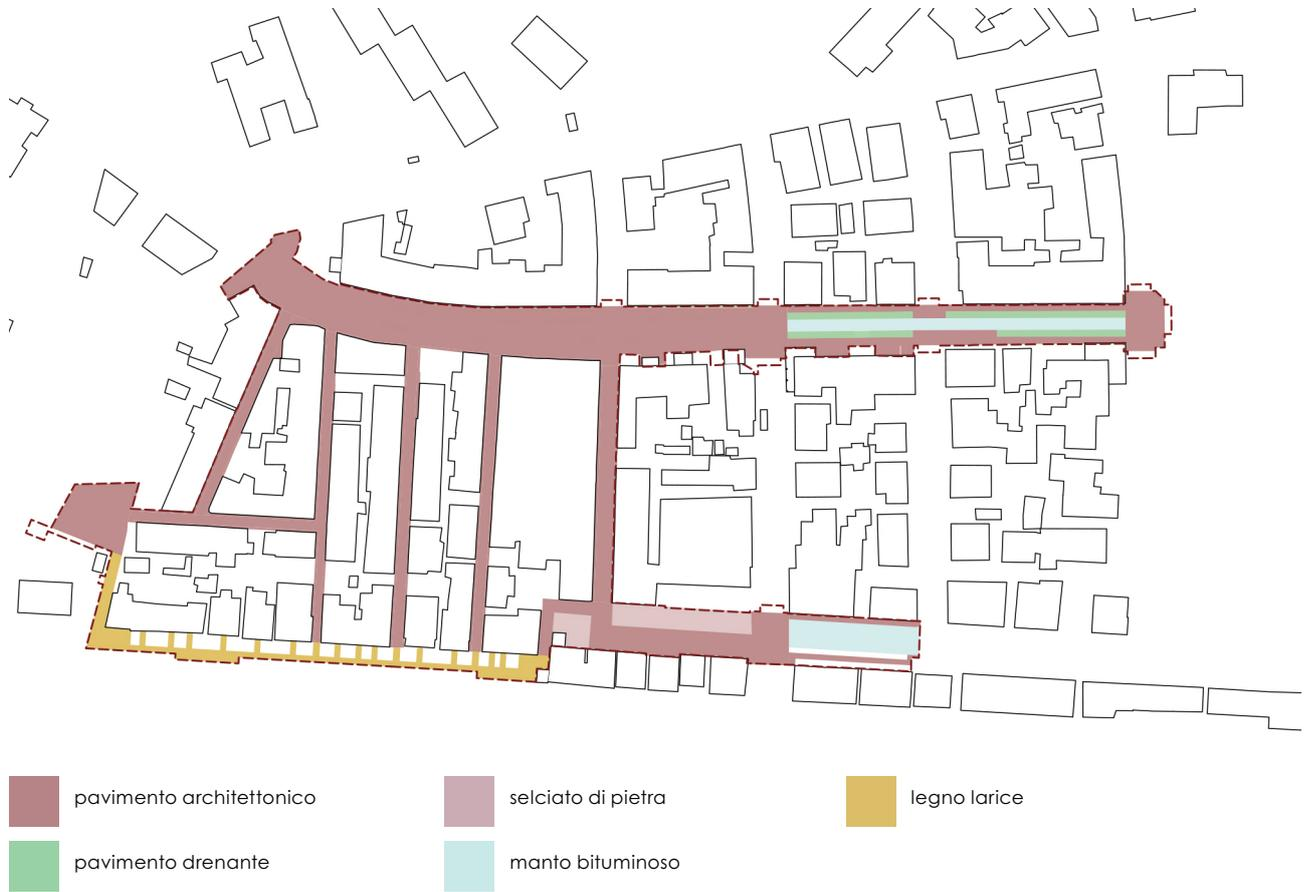
Schema di distribuzione delle pavimentazioni sull'area del progetto definitivo
