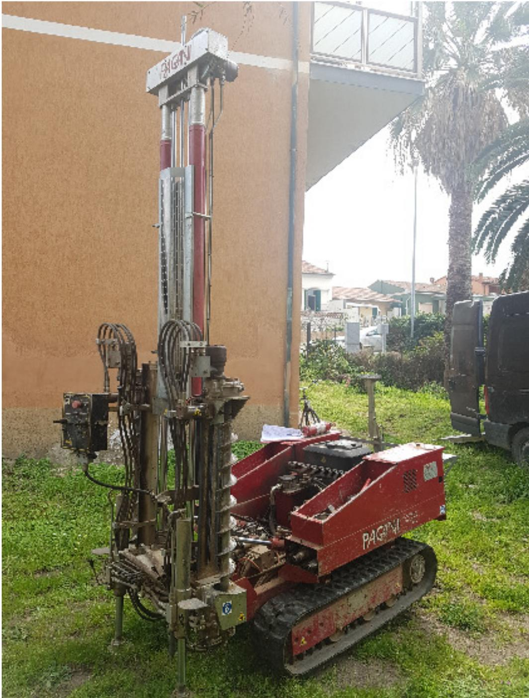
**PROVA PENETROMETRICA DINAMICA DPSH 1**
