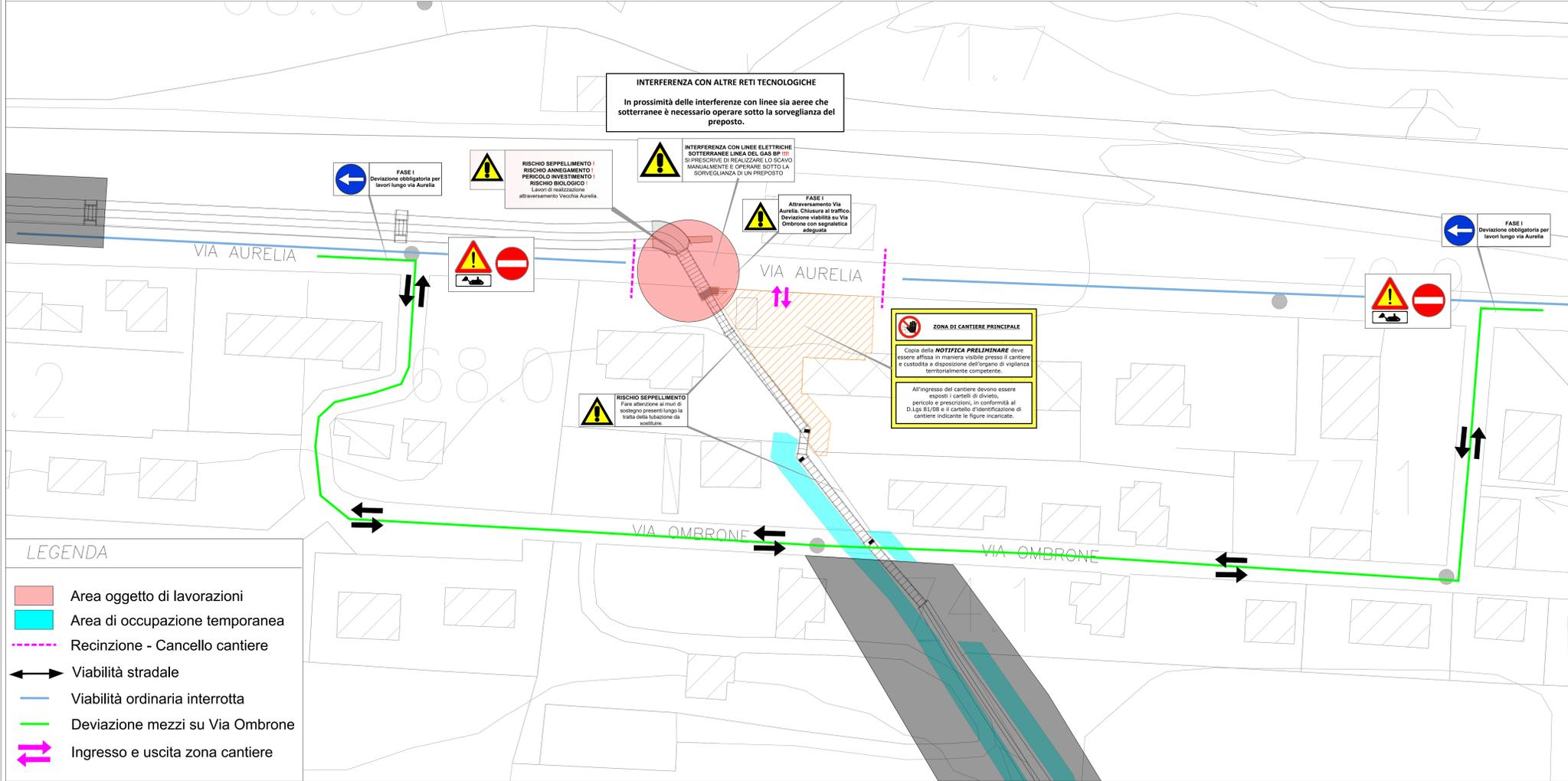
Layout cantiere fase II - Attraversamento Via Ombrone - Scala 1:500
