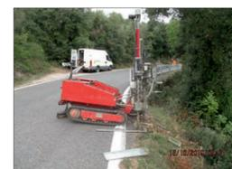
Foto 3a - Fase di realizzazione prova penetrometrica DPSH3
