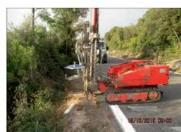
Foto 2a - Fase di realizzazione prova penetrometrica DPSH2
