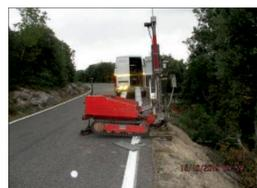
Foto 4a - Fase di realizzazione prova penetrometrica DPSH4
