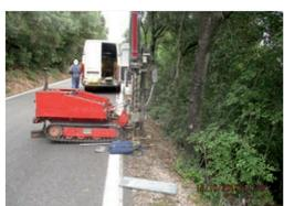
Foto 6a - Fase di realizzazione prova penetrometrica DPSH6
