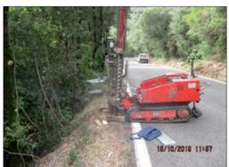
Foto 7a - Fase di realizzazione prova penetrometrica DPSH7
